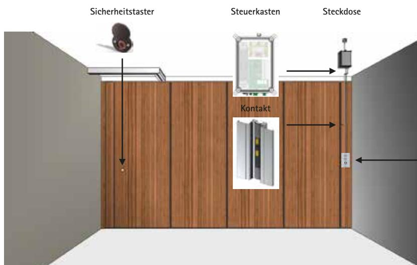
Abb. 7: Trennwandanlage – Bedienvariante teilautomatisch
