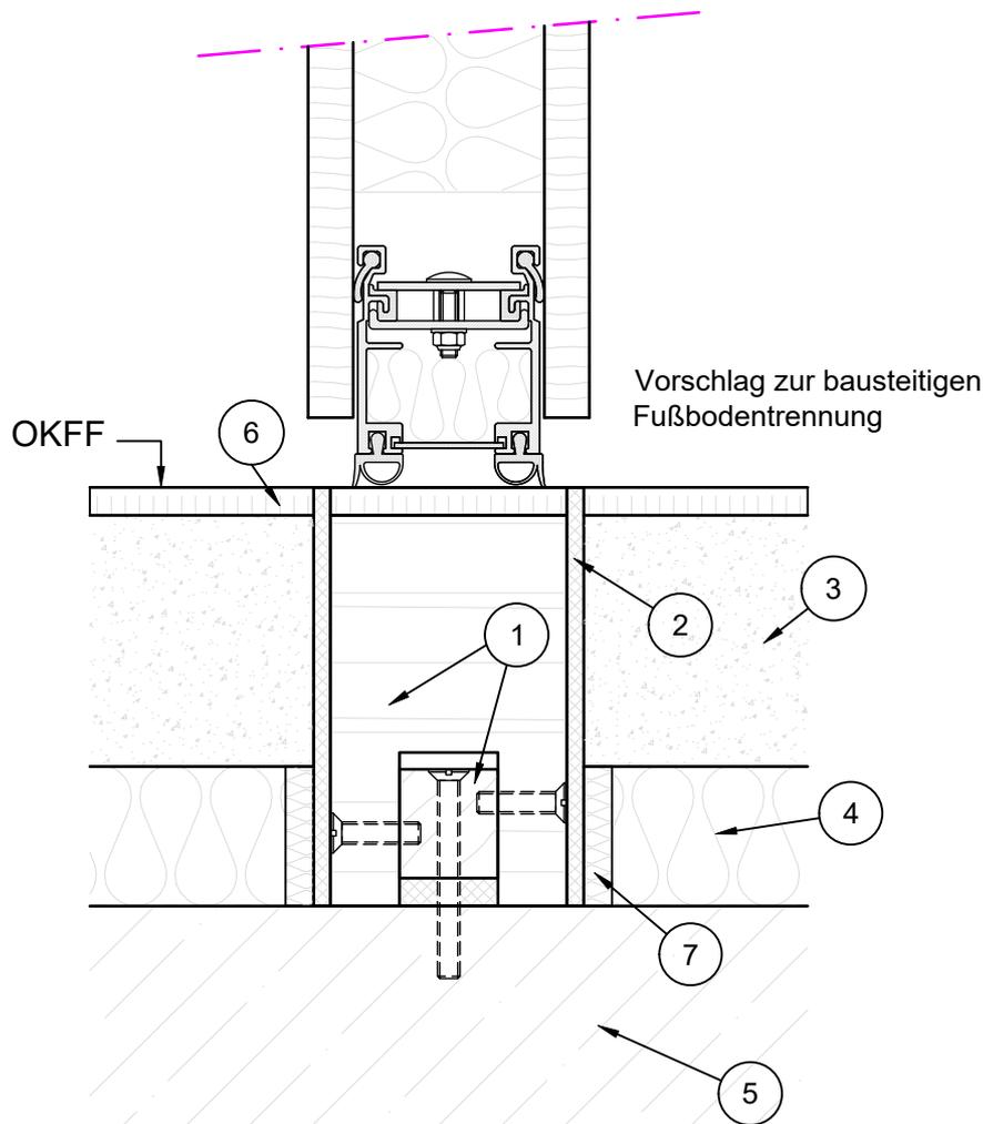
1. Verleimte Multiplex-Sperrholzplatte
