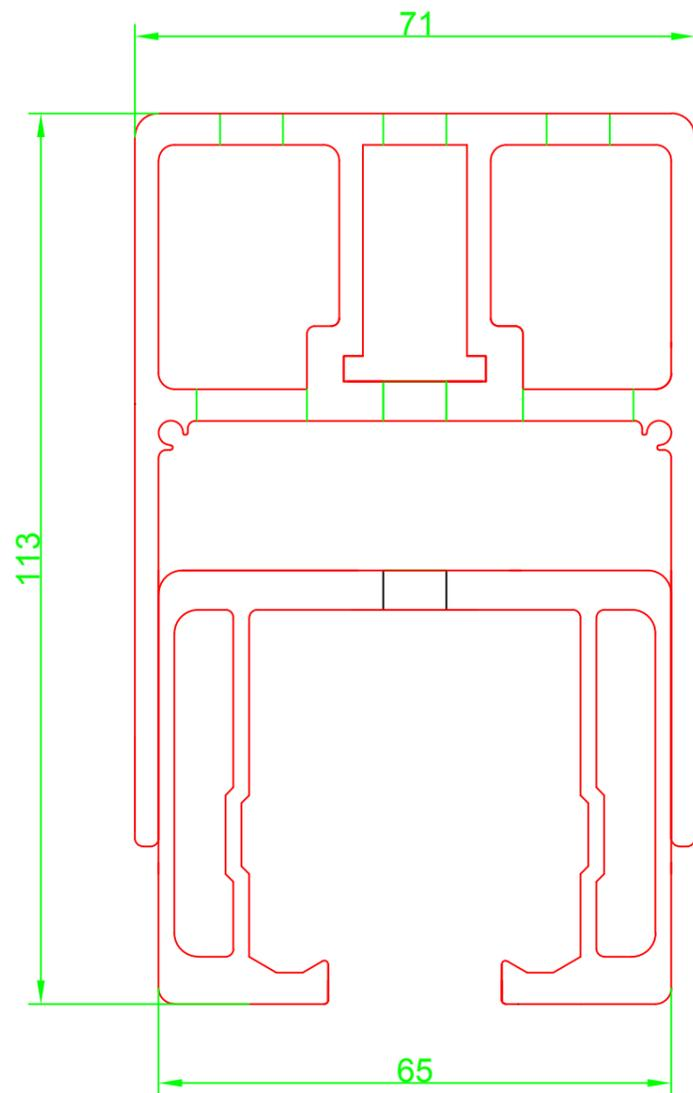
Laufschiene mit Deckenwinkel
