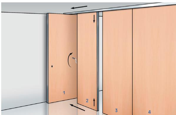
Verfahren Sie das Element (Nr. 1) quer zur Laufschiene in die Parkstellung vor der Wand. Um das nächste Element (Nr. 2) zu entriegeln, führen Sie die Bedienkurbel stirnseitig in das Element (Nr. 2) ein und kurbeln Sie links herum bis zum Anschlag. Die horizontalen Druckbalken werden eingefahren und Sie können das Element (Nr.2) aus der Nut-Feder-Verbindung ziehen.
