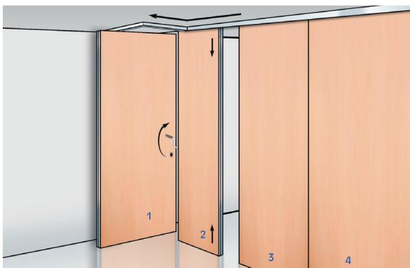
Fahren Sie das Teleskopelement (Nr. 1) in die endgültige Parkstellung. Um das nächste Element (Nr. 2) zu entriegeln, führen Sie die Bedienkurbel stirnseitig in das Element (Nr. 2) ein und kurbeln Sie links herum bis zum Anschlag. Die horizontalen Druckbalken fahren ein und Sie können das Element (Nr. 2) aus der Nut-Feder-Verbindung ziehen.
