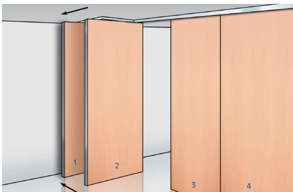
Fahren Sie auch dieses Element (Nr. 2) soweit, bis die Rolle in der Schienenabzweigung steht und ziehen Sie gleichzeitig das Element (Nr. 2) in Richtung Abfahrtschiene. Sie können dieses Element (Nr. 2) nun in die endgültige Parkstellung verfahren.
