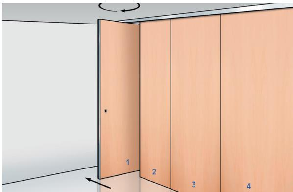
Sie können jetzt das Element Nr. 1 aus der Nut-Feder-Verbindung ziehen. Nutzen Sie dabei die Bedienkurbel als Hebel. Fahren Sie das Element (Nr. 1) soweit, bis die Rolle in der Schienenabzweigung steht und ziehen Sie gleichzeitig das Element in Richtung Abfahrtschiene.
